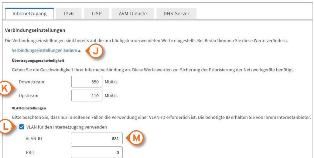
Setzen Sie das Häkchen bei „VLAN für den Internetzugang verwenden“ (L) und tragen Sie anschließend in das Feld die VLAN ID „681“ (M) ein.
