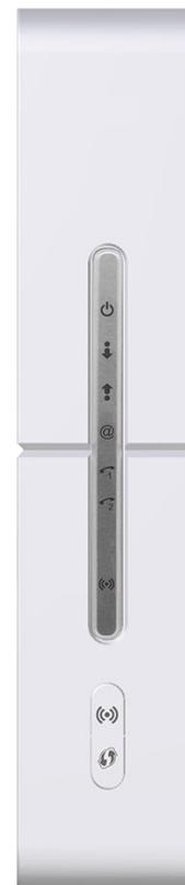
Sollten die LEDs nach mehr als 10 Minuten noch immer nicht den gewünschten Status anzeigen und kommen Sie weder mit verbundenen Endgeräten ins Internet noch können Sie sachgemäß angeschlossene Telefone nutzen, kontaktieren Sie uns bitte unseren Technischen Service über die unter [Kontaktinformationen](#) angegebenen Wege.
