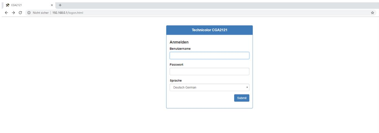
**Achtung** Nach der ersten Anmeldung wird empfohlen, das Kennwort für die Modemkonfiguration zu ändern, sowie das Kennwort, das für die Verbindung mit dem WLAN-Netzwerk erforderlich ist. Dies kann über die Geräteverwaltungsseite auf den in Abschnitt 4.2.4 beschriebenen Registerkarten erfolgen.
