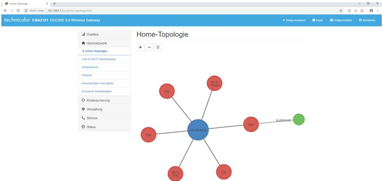
Die Registerkarte zeigt Topologien aktiver Verbindungen in LAN und WLAN an.
