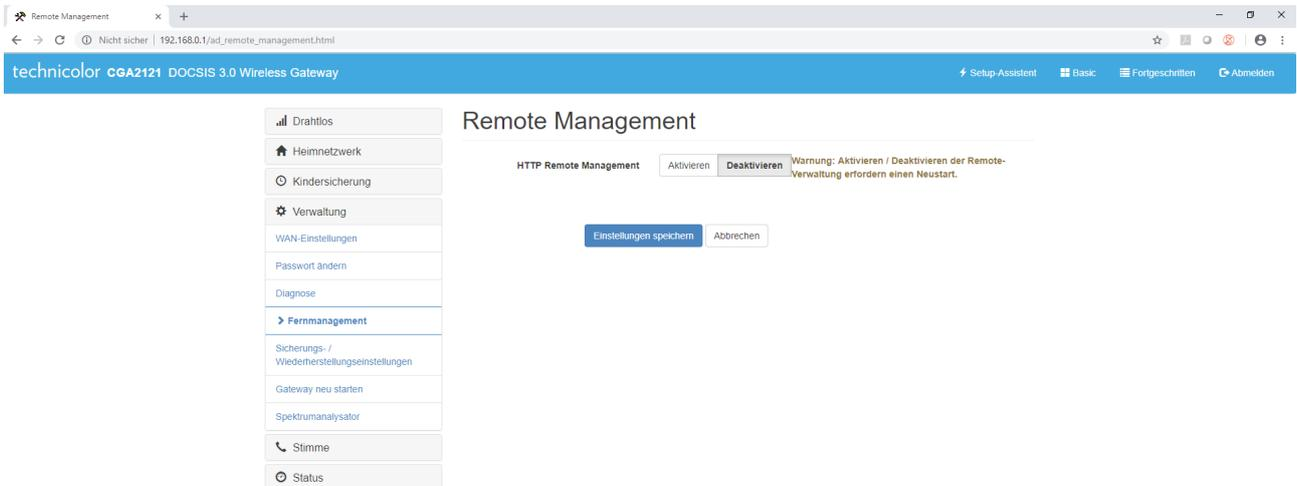
Diese Registerkarte ermöglicht die Konfiguration des Fernzugriffs auf die Modemverwaltung.
