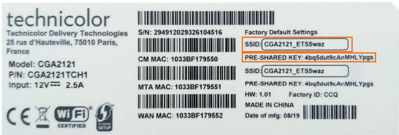
Die Standard-WLAN-Konfiguration verwendet das WPA2 Personal (PSK)-Protokoll und die AES-Verschlüsselung. Wenn ihr Gerät diese Protokolle nicht unterstützt, stellen Sie über ein Ethernetkabel eine Verbindung zum Modem mit dem LAN-Port her, melden Sie sich bei der Verwaltungsseite an und ändern Sie die Standardkonfiguration des drahtlosen Netzwerks.
