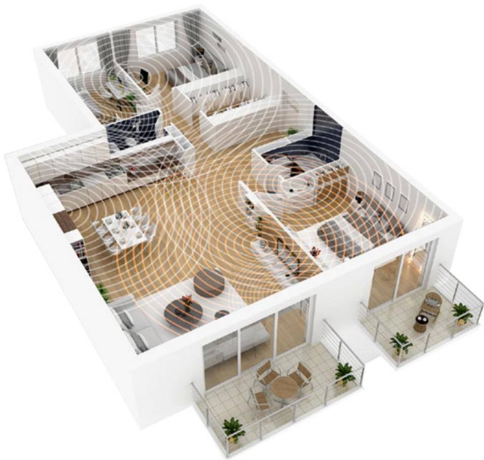
Der Komfort kabelloser Bedienung und Kommunikation bringt eine Überlagerung mehrerer Funkfrequenzen mit sich. Diese können das WLAN beeinträchtigen. Gewöhnlich funkt WLAN im 2,4-GHz-Frequenzband, ebenso wie z. B. **Bluetooth**, **DECT-Telefone** oder **Babyfone**. Sogar nah am WLAN-Router platzierte **Mikrowellen** können stören, da diese ebenfalls Frequenzen aus diesem Band nutzen.
